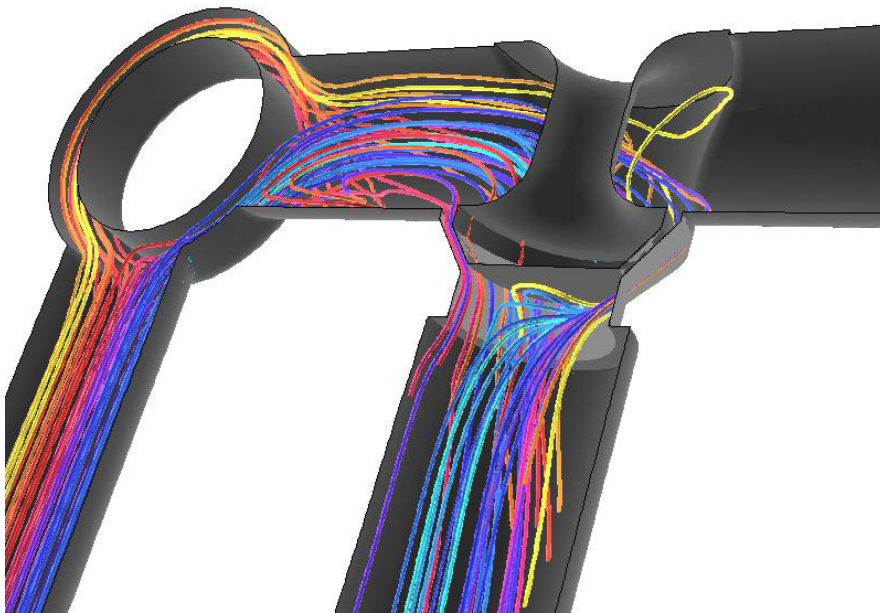
Figura 7.7: Linee di flusso in una valvola di bypass oleodinamica (Facoltà di Ingegneria di Modena, FLUENT)
