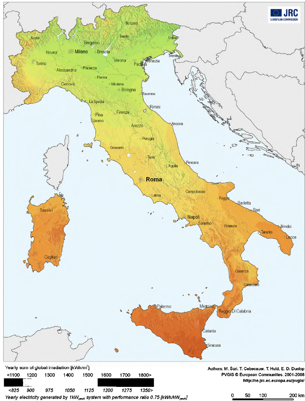
Figura 2.17: Irradiazione solare media annuale in Italia incidente su superfici orizzontali, espressa in chilowattora per metro quadrato ed anno [Fonte PVGIS ©European Communities 2001-2008].
