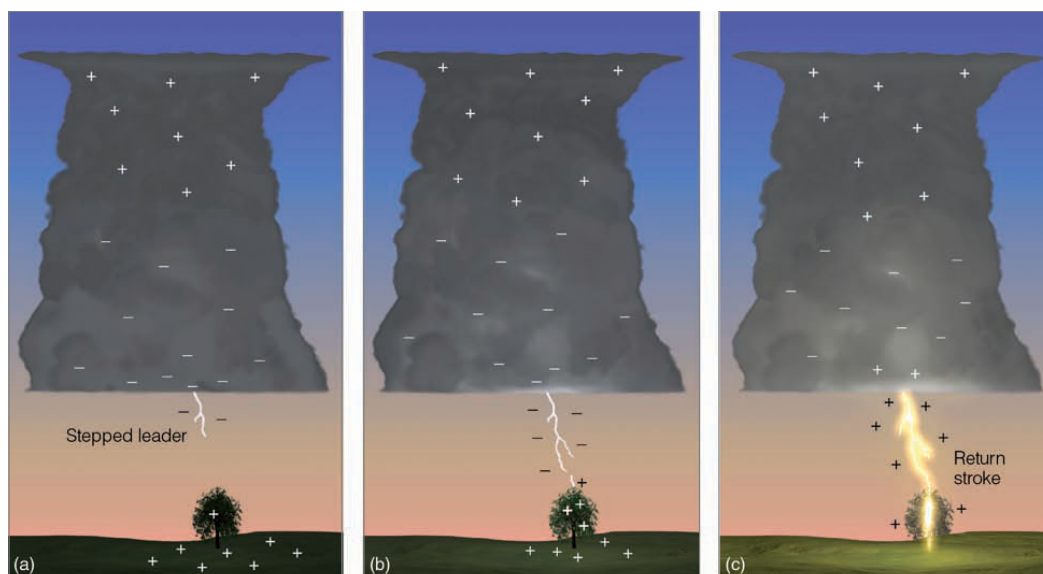
Figura 6.17: Fasi di un fulmine negativo: partenza della scarica pilota a sinistra; risalita degli ioni positivi attraverso un conduttore alto al centro; scarica di ritorno a destra [C. D. Ahrens e R. Henson].
